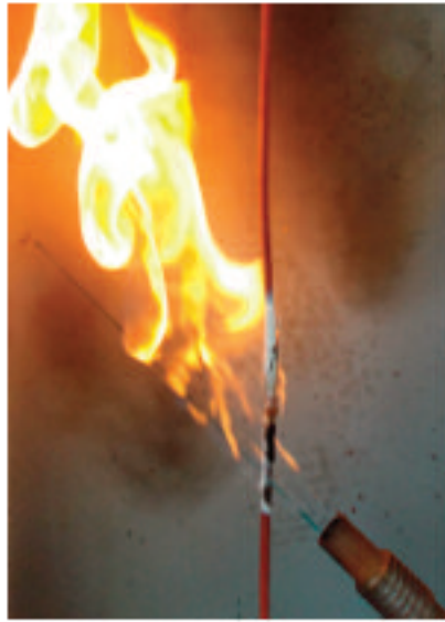
Flammtest eines Kabels
